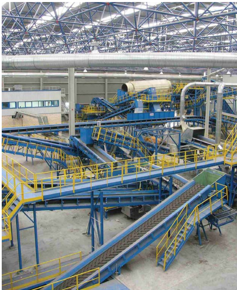
El Ecoparque cuenta con diversos y variados sistemas, automáticos y manuales, para clasificar los residuos por materiales, por tamaños y por punto de destino.
