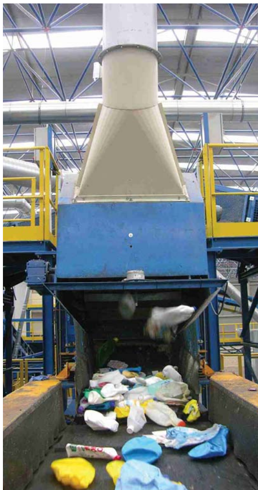
El Ecoparque cuenta con diversos y variados sistemas, automáticos y manuales, para clasificar los residuos por materiales, por tamaños y por punto de destino.
